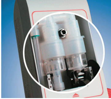
Büret çarkı çevrildiğinde sıvı çift piston pompa tarafında sürekli pompalanır.
